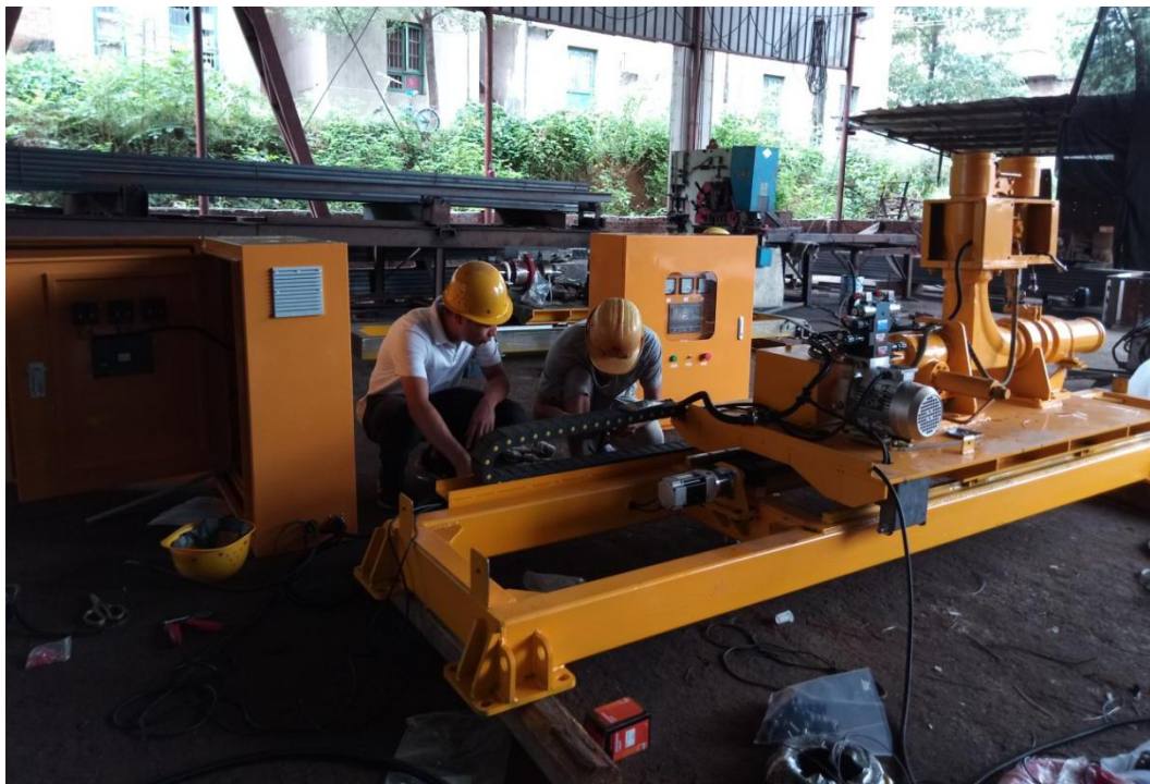
图 5-5 二衬台车调试现场
